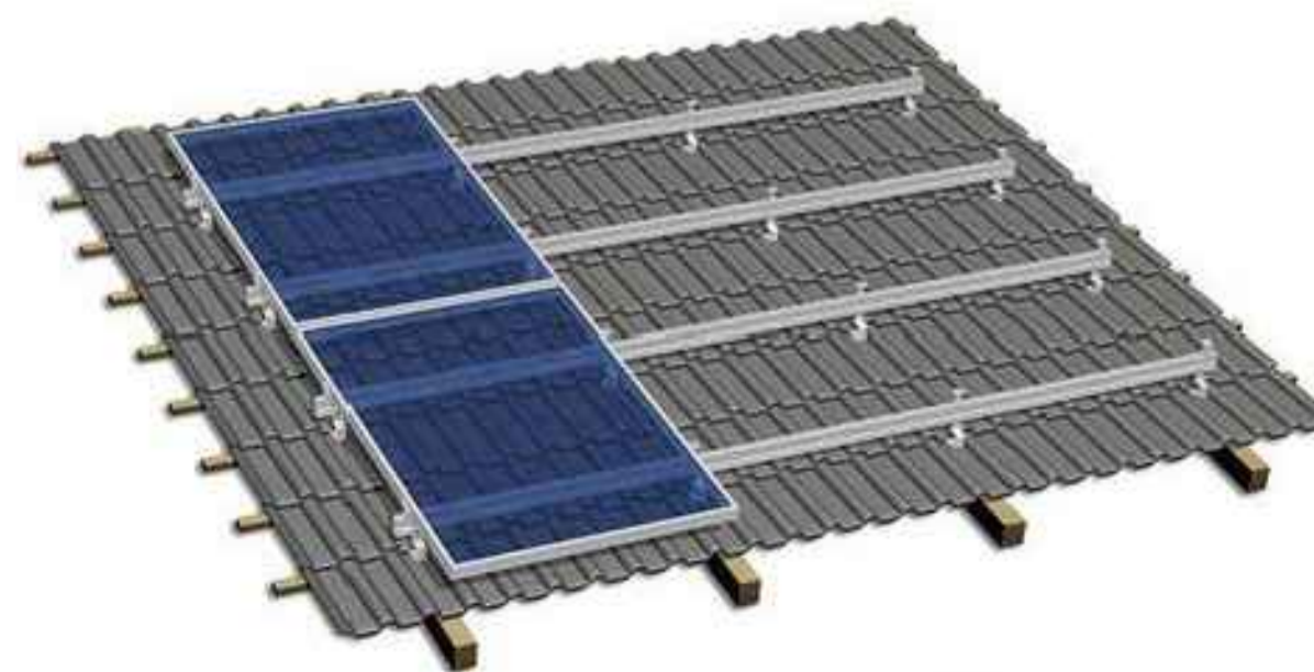
TIPOLOGIA INSTALLATIVA TETTO A FALDE INCLINATE
