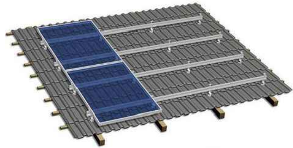
TIPOLOGIA INSTALLATIVA TETTO A FALDE INCLINATE
