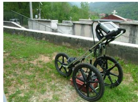
*Strumentazione georadar: unità principale, antenna e carrello*
