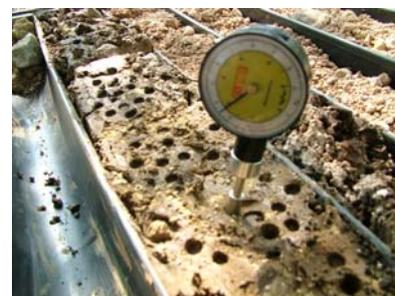
*Esempio di prova Pocket Penetrometer*
