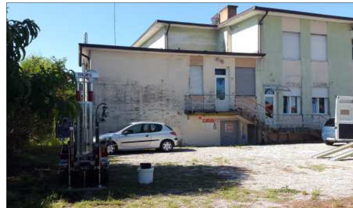
Esecuzione dell'indagine penetrometrica dinamica superpesante D.P.S.H.
