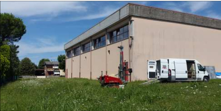
Esecuzione dell'indagine penetrometrica dinamica superpesante D.P.S.H.
