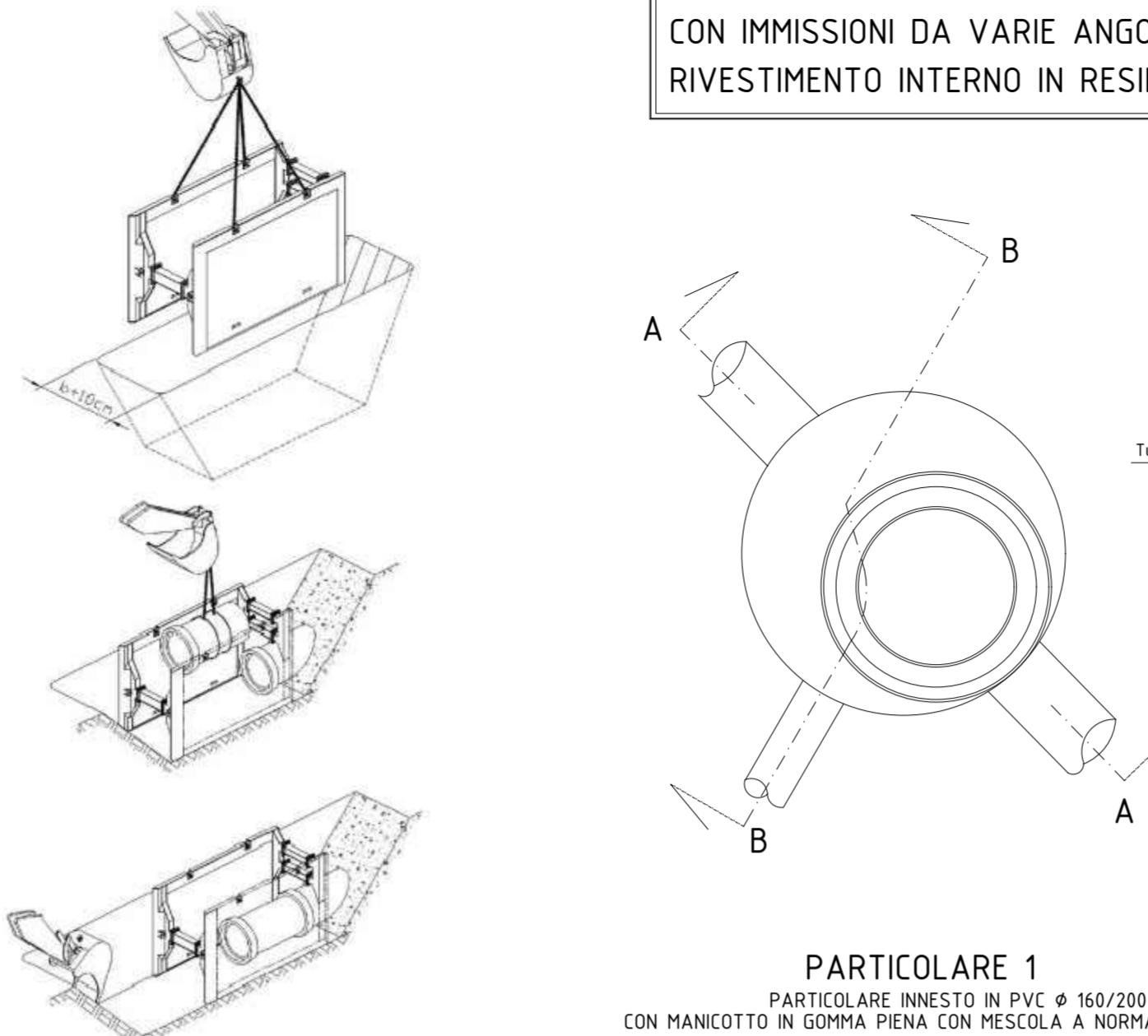
POZZETTO D'ISPEZIONE MONOLITICO  $\phi$  800
