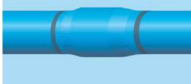
Il processo di contrazione è terminato quando il manicotto aderisce contro la parete del tubo in modo completo ed in assenza di bolle d'aria, mentre l'adesivo è stato spinto su entrambi i lati in modo omogeneo verso l'esterno.
