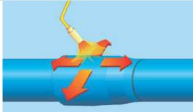
Effettuare un riscaldamento omogeneo del manicotto termorestringente mediante una torcia a gas propano a bassa regolazione, a partire dalla mezzaria del manicotto in direzione radiale verso l'esterno, così da causare l'espulsione di aria e di umidità in senso laterale.
