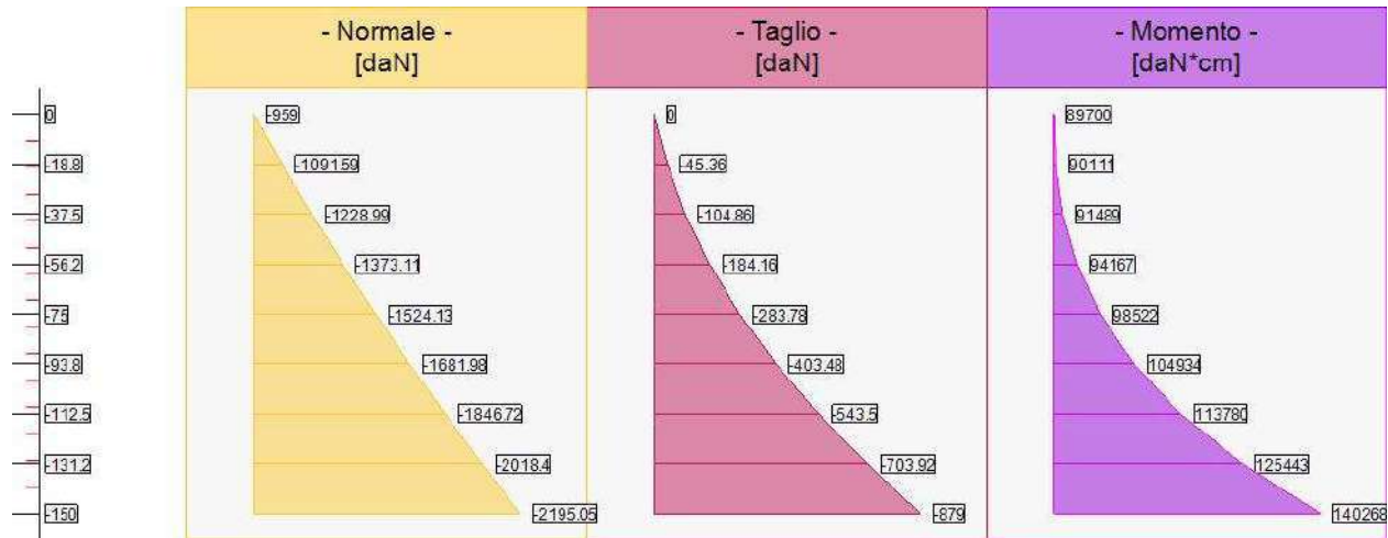
Sollecitazioni lungo il fusto, per il Caso 6 ( RARA [ Caratteristica ] - SLE caratteristica ( rara )
