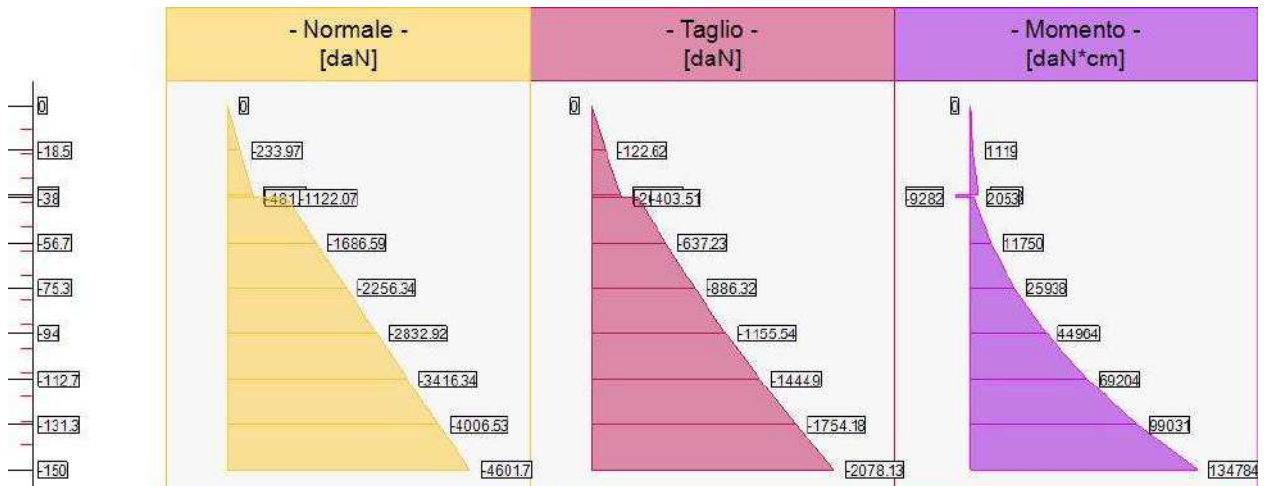
Sollecitazioni lungo il fusto, per il Caso 3 ( SLV_SISMA_GIU [ SLV ] - Sisma_1+1+R_Giu )
