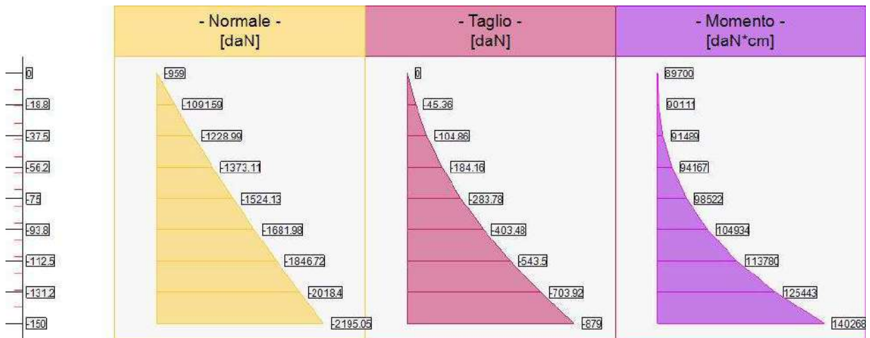
Sollecitazioni lungo il fusto, per il Caso 7 ( FREQ. [ Frequente ] - SLE frequente )
