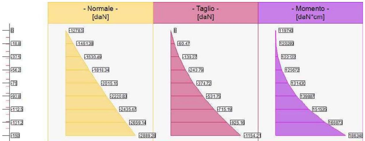
Sollecitazioni lungo il fusto, per il Caso 1 ( STR [ SLU ] - SLU A1+M1+R3 )
