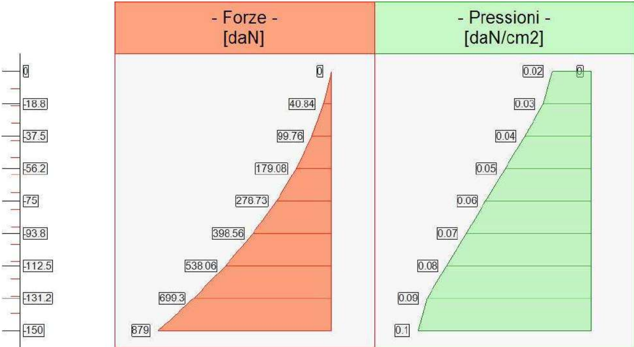
Forze (totali) e Pressioni lungo il fusto, per il Caso 7 ( FREQ. [ Frequente ] - SLE frequente )
