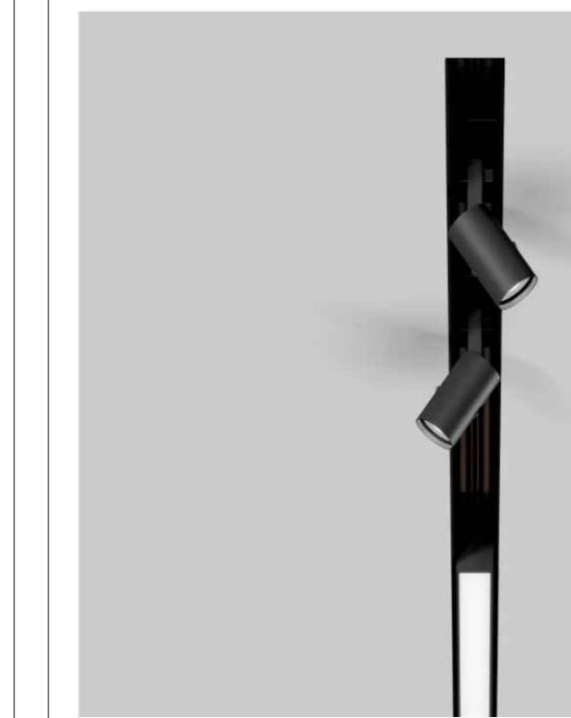
Profilo in alluminio pressofuso con fuga larga 25 mm, per incasso a filo in controsoffitti di gesso dello spessore di 12,5 mm, concepito per sistemi d'illuminazione su filo continuo, superficie decapata e nera opaca anodizzata, montaggio flessibile degli inserti con fissaggio magnetico senza ausilio di utensili, dimmerabile DALI.
