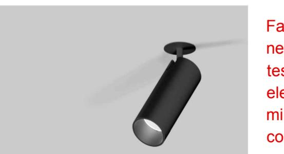
Faretto in alluminio pressofuso; Superficie verniciata a polveri in bianco o nero; Testa del faro girevole 355° e orient. 90°; Convertitore integrato nella testa del faro; assenza di ombre multiple; LED ad efficienza energetica con elevata resa cromatica; colore della luce 2700 K e 3000 K; CRI ≥ 90; 80 % min. del flusso lumin. dopo 50000 h di durata di vita; riflettore di alta qualità con ottica a sfaccettature sferiche;
