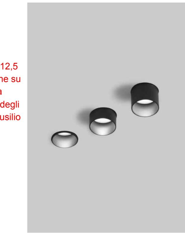
Elemento faretto rotondo in alluminio; Superficie verniciata in grigio o nero; incasso a scomparsa in soffitti di cartongesso; regolabile in altezza senza attrezzi; livello soffitto o sporgente di 25 mm o 35 mm; raffredd. passivo LED grazie alla geometria ottimizzata del raffreddatore; assenza di ombre multiple; LED ad efficienza energetica con elevata resa cromatica; colore della luce 2700 K e 3000 K; % dimmerabile DALI;
