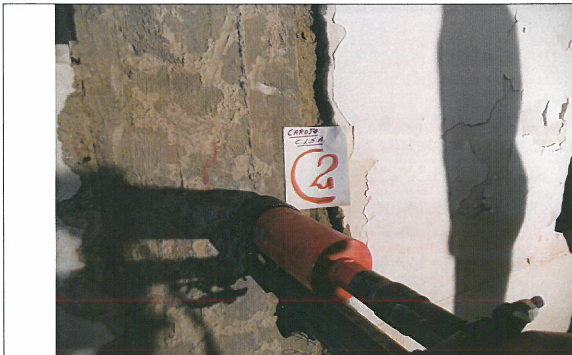
PRELIEVO CAROTA C.S.A. C2 DAL PILASTRO P2
