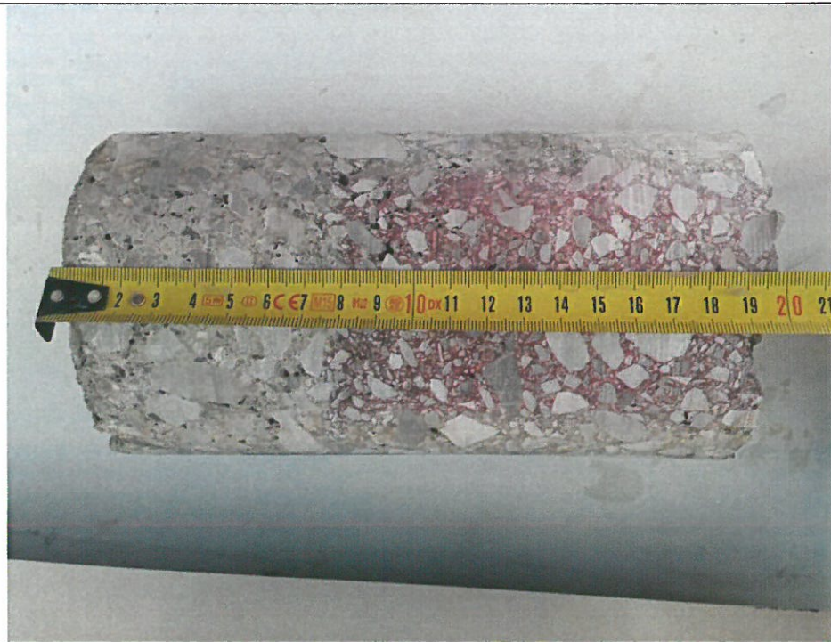
PROVA DI "CARBONATAZIONE" - C1
