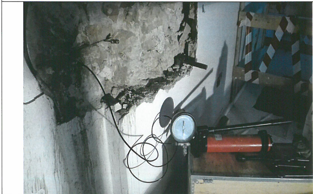
PROVA "M1" CON SINGOLO MARTINETTO PIATTO
