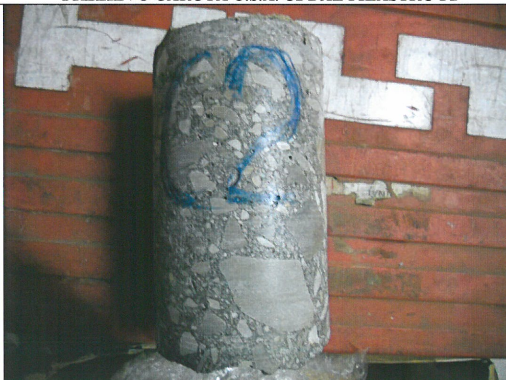
PRELIEVO CAROTA C.S.A. C2 DAL PILASTRO P2
