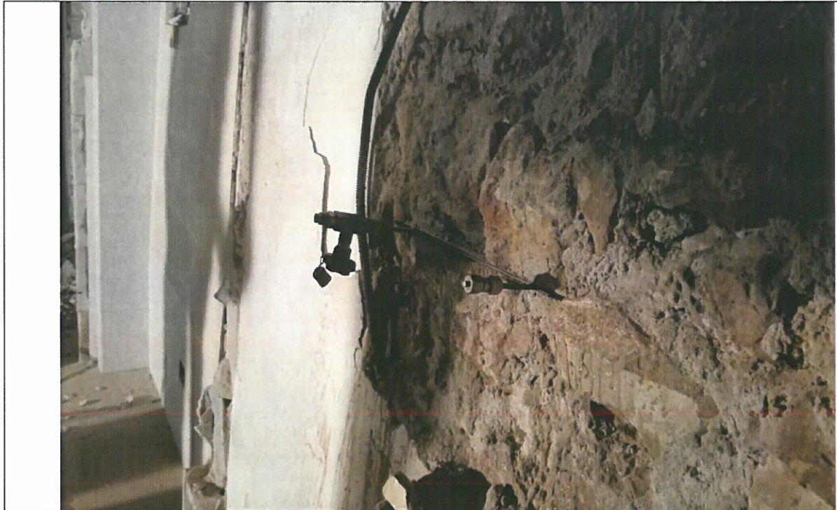
PROVA "M1" CON SINGOLO MARTINETTO PIATTO
