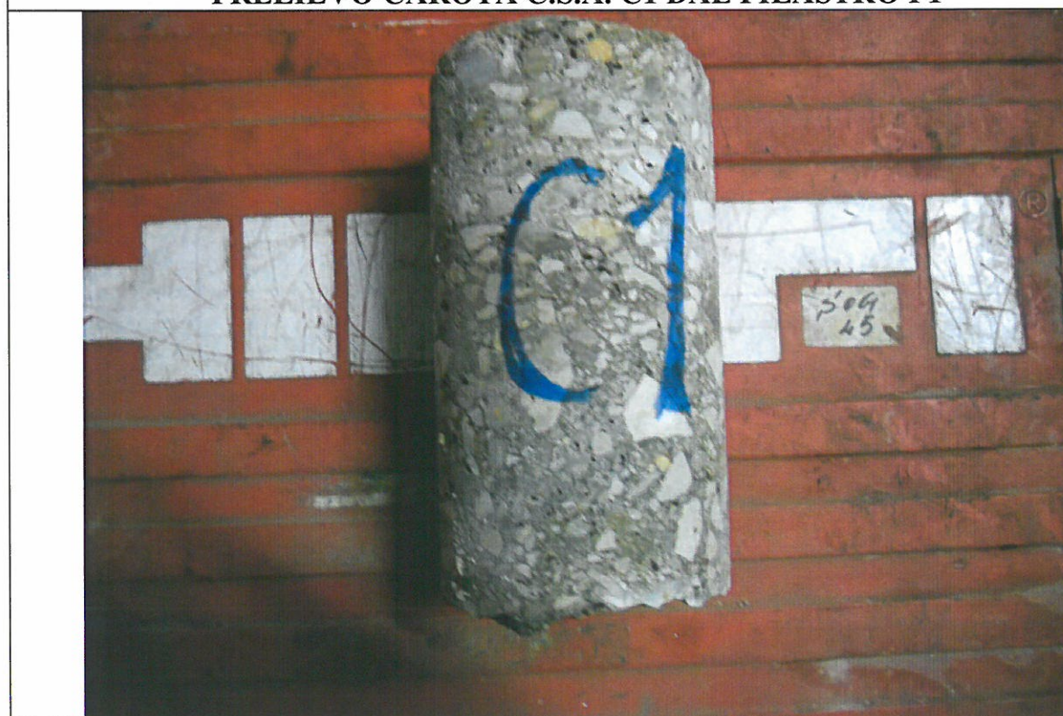
PRELIEVO CAROTA C.S.A. C1 DAL PILASTRO P1
